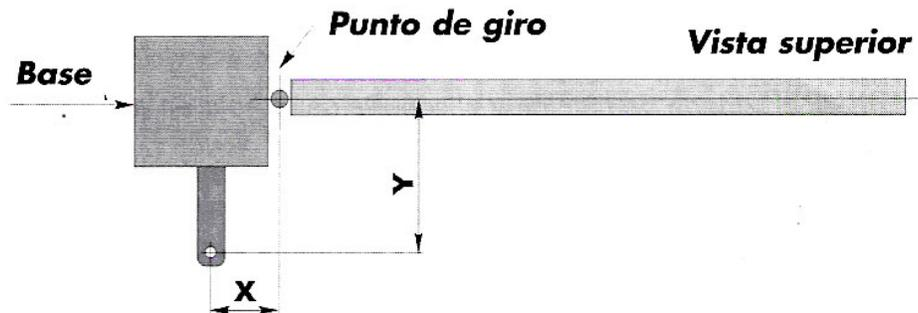
En caso que el portón sea de apertura externa, fije al muro o reja con un ángulo de 90° , una placa de 20x20cm x 1/4" , que será la base del soporte de sustentación. Suelde en esta placa el soporte de fijación conforme el sentido de apertura la sustentación del esquema mostrado abajo.
